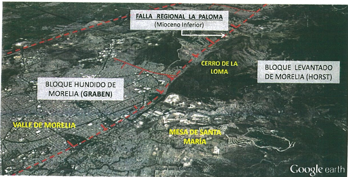
Figura 3. Imagen satelital de la Ciudad de Morelia, indicando la traza de la falla la Paloma como uno de los rasgos estructurales de la zona que controla su relieve. Al norte de la falla se presenta el bloque hundido (Graben) y al sur de la falla un pilar o alto estructural (horst).
